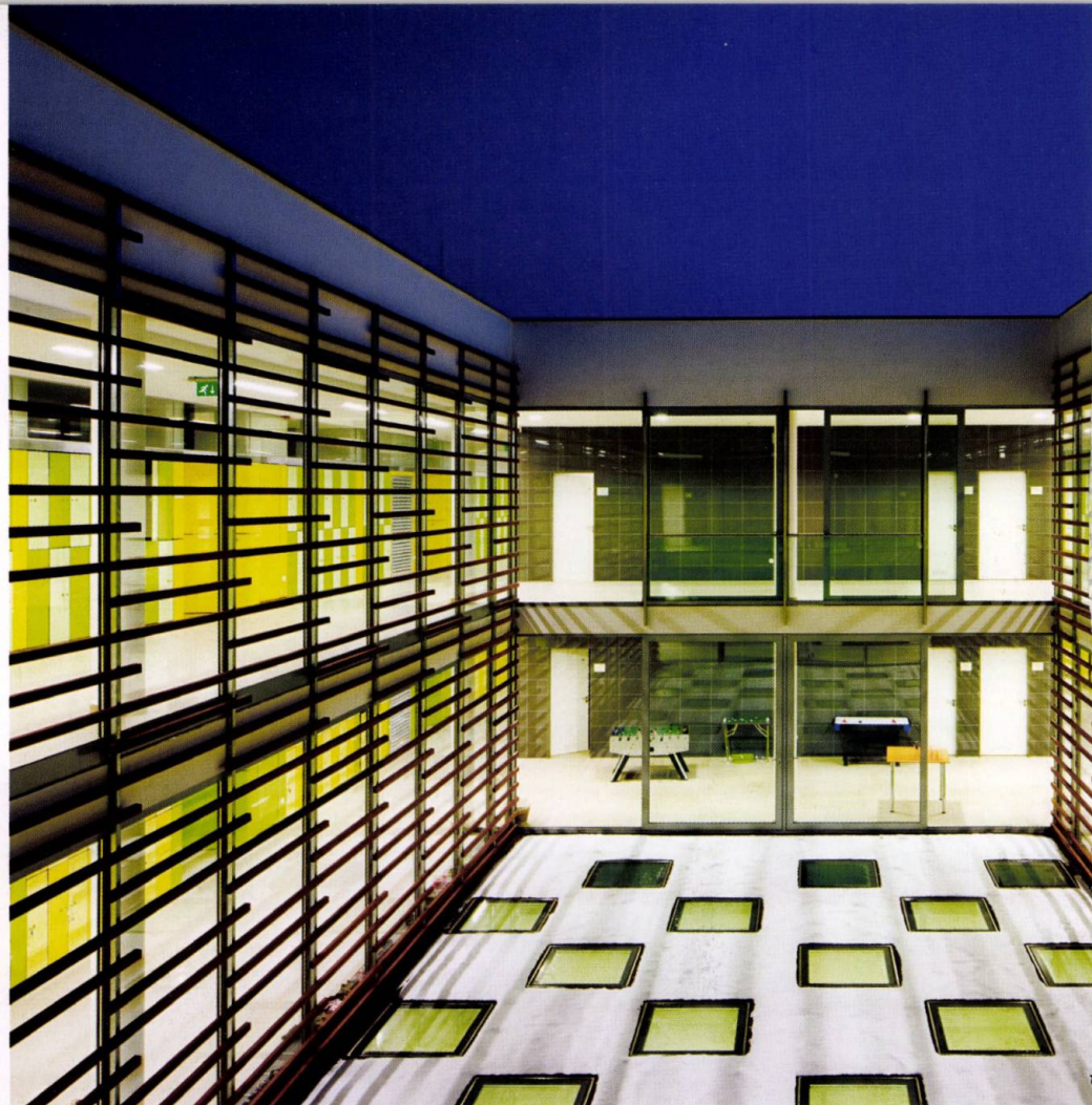
Az iskola különlegessége a második és a harmadik emeleten kialakított két átrium. A járható felületű udvarok gondoskodnak a különböző szintek bevilágításáról és a természetes szellőzésről
